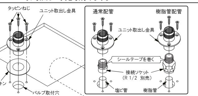
①仕上げ床のバルブ取付穴にユニット取出し金具を固定できるように、給水配管を接続します。
